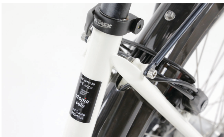
RECHTS Die nach heutigem Stil eher dünnen Rohre und Rohrverbindungen des Rahmens zeugen davon, dass hier Stahl als Rahmenmaterial zum Einsatz gekommen ist. Die Rohre sind aus hochfestem und doch elastischem Chrom-Molybdän-Stahl und werden in den Niederlanden in einer Manufaktur zum Rahmen verarbeitet. Heute etwas sehr seltenes.
